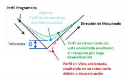
**Interpolación Inteligente** garantiza la precisión de maquinado al preformar la aceleración y desaceleración antes de la interpolación del perfil.
